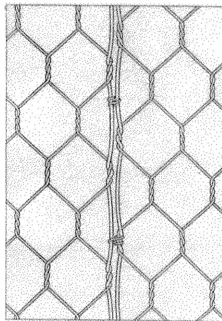
(spojovanie sponami je najvhodnejší a preto odporúčaný spôsob spojovania sien gabion-matracov i gabion-matracov v konštrukcii navzájom, ktorý vykazuje minimálnu voľnosť spoja a maximálnu pevnosť a životnosť spojov; použitím náradia sa urýchluje výstavba a práca je zaujímavejšia)
